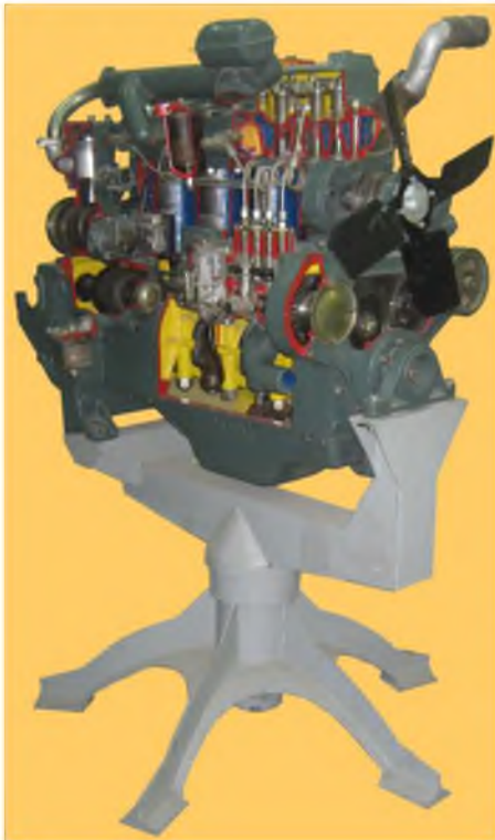
Двигатель Д-60 на поворотной стойке с вертикальной осью вращения
