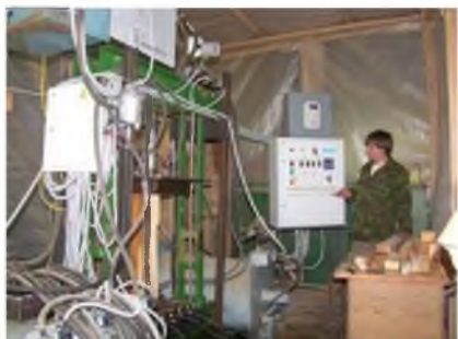
Установка для аэрозольной пропитки древесины НКЦ
