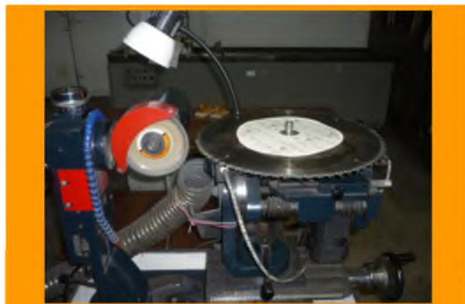
Пример применения ВДПСТ на станке для заточки пил VM 1630 (зажимной фланец снят)
