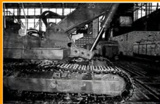
Гидравлический экскаватор ЭО-5225 с усовершенствованной конструкцией СПМ.
