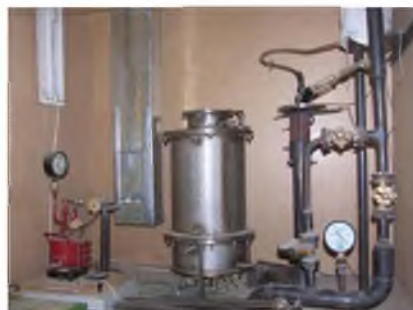
Установка металлизации древесины, пропитанной НКЦ
