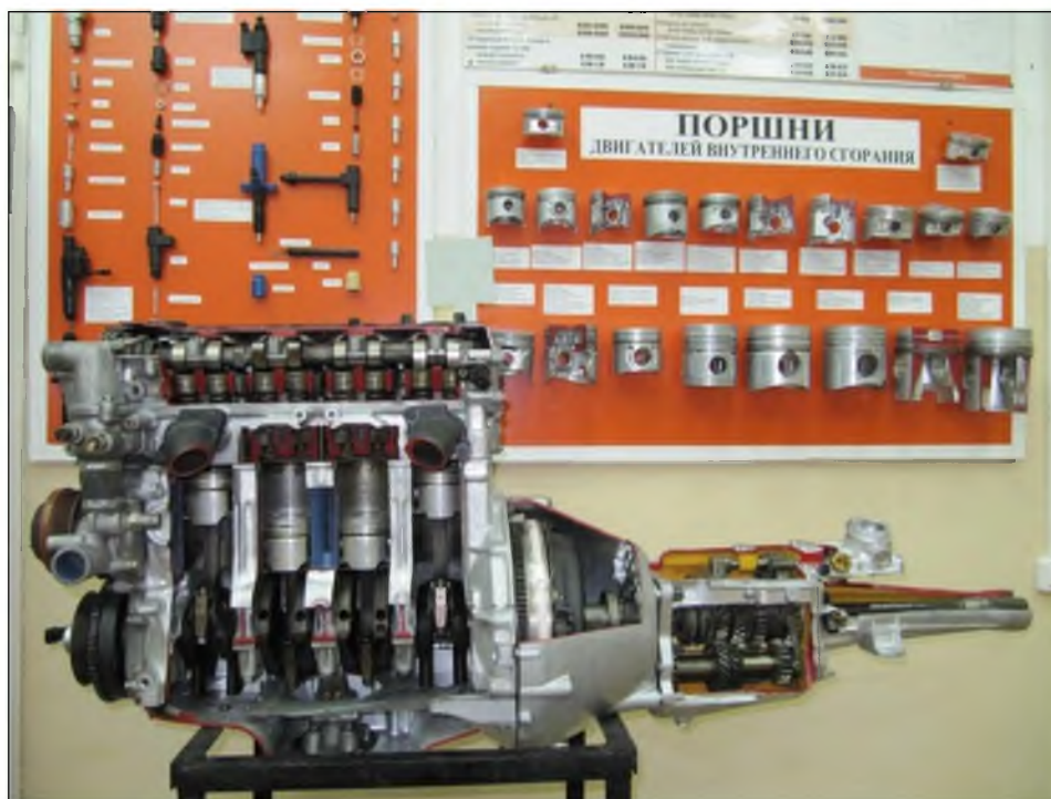
Стенд-агрегат автомобильной энергетической установки поршневого типа с элементами трансмиссии в сочетании со стенд-блоками поршней и форсунок
