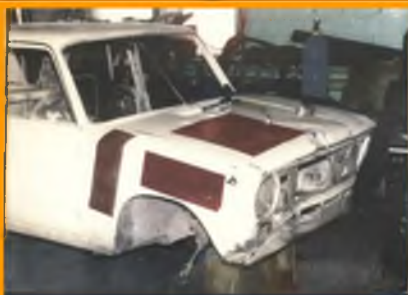
Применение СВП (вариант 1 – «универсальный») для снижения шума при кузовных работах на ОАО «Воронежавтосервис»
