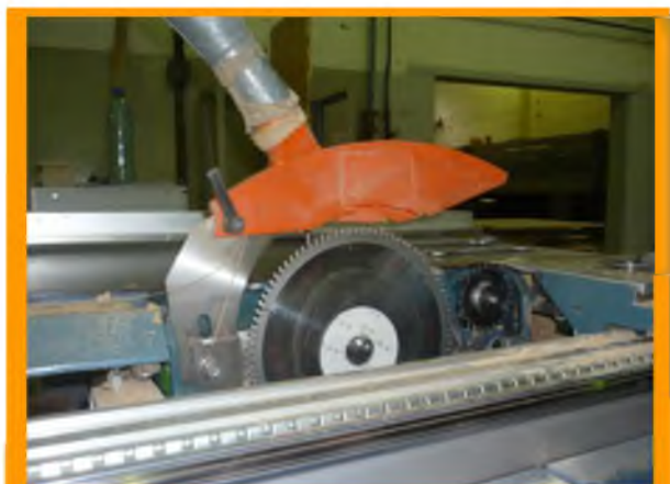
Пример применения ВДПСТ на деревообрабатывающем станке ЦДК-40 (зажимной фланец снят)
