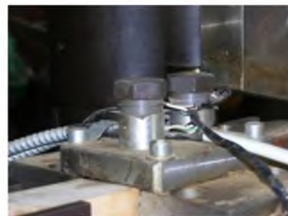
Установка для обработки древесины ультразвуком, пропитанной НКЦ
