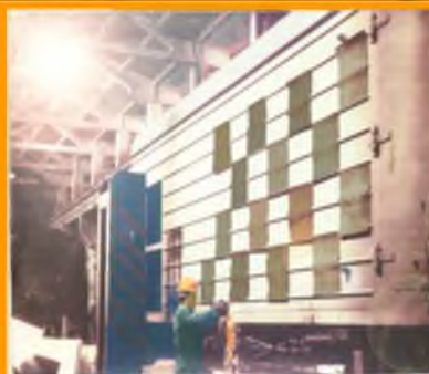
Применение СВП для снижения шума при обработке поверхностей обшивки вагона-рефрижератора (фрагмент капитального ремонта вагона)
