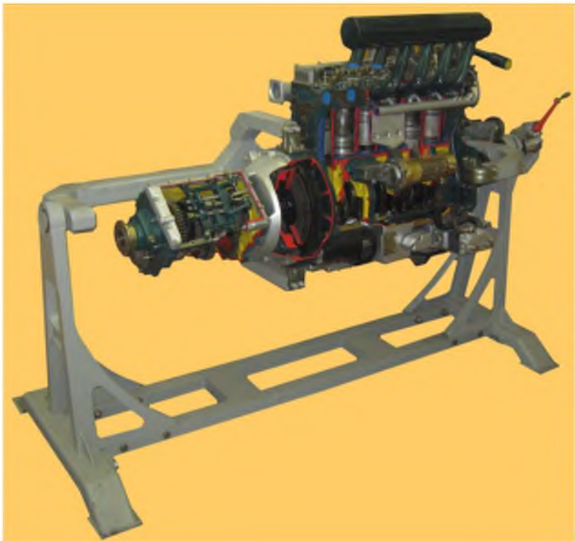
Силовой агрегат RABA-MAN на стойке с горизонтальной осью вращения, оснащенной редуктором
