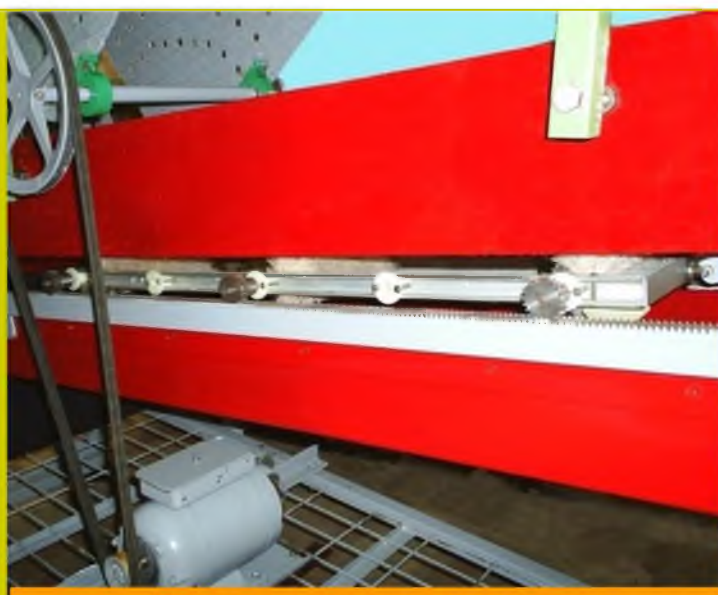
Механизм очистки решет с активными цилиндрическими щеточными рабочими органами (Пат. № 34407 РФ)
