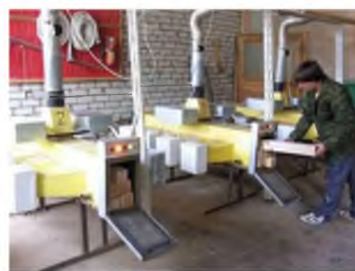
СВЧ-сушильная камера для сушки древесины, пропитанной НКЦ
